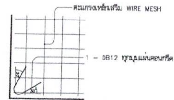
ขยายการเสริมเหล็กคานยาว SCALE: 1:50
