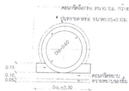
รูปตัดทอระบายน้ำ เชื่อมต่ออพัก-บ่อพัก SCALE 1:25
