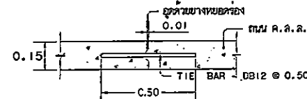
LONGITUDINAL JOINT 1:20
